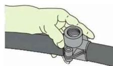
Assembler les 2 parties du collier autour du tuyau, poser les vis de fixation et serrer.
