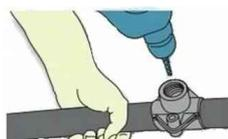
Percer le tuyau. Ebavurer et retirer les copeaux.
