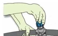
Positionner et serrer la sonde de température sur le collier.
