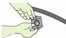
Positionner le joint torique sur le collier avant assemblage sur le tuyau.
